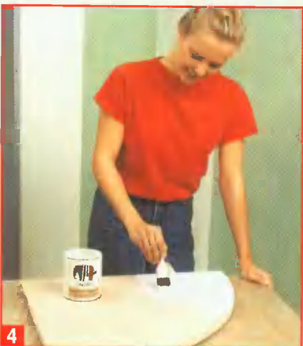
4 Выкроенный из ДСП квадрант грунтувают, одновременно заделывая мелкие трещины.
