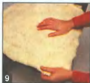
9 Слой ваты толщиной около 10 мм выравнивает последние неровности будущего сиденья.
