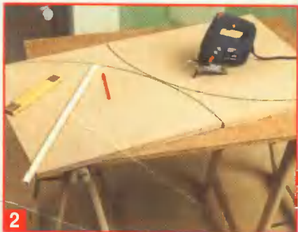
2 Полки выкраивают из ДСП электролобзиком, предварительно разметив их контуры с помощью самодельного циркуля — рейки, которая прикреплена гвоздем одним концом в углу плиты.
