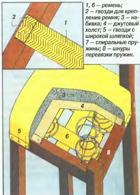
Рис. 1. Внутреннее устройство мягкого стула:
