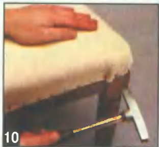
10 Бязевую обивку натягивают поверх настила из ваты и крепят скобками или гвоздями.
