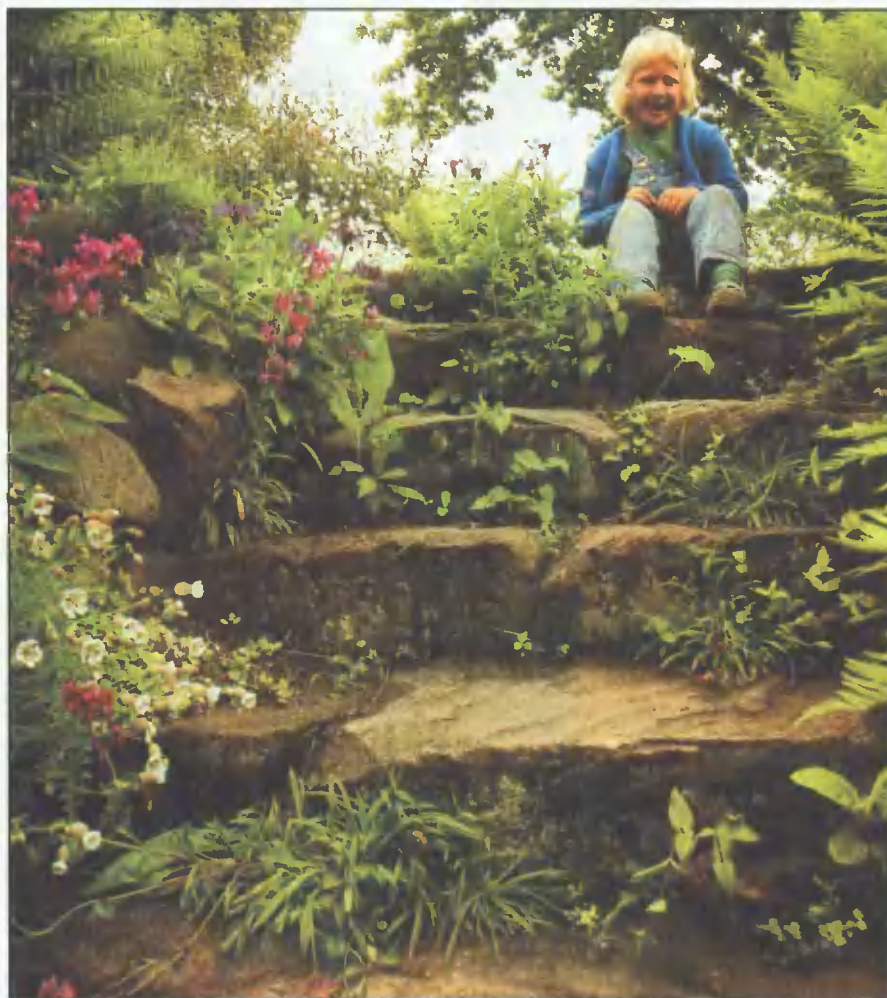
4 Ступени из бетонных или каменных плит очень удобны, однако требуют предварительного возведения морозостойкого фундамента.
