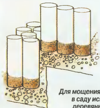
Круглые плиты из бетона с обнаженным заполнителем изготавливают следующим образом: на ровное основание кладут форму, представляющую собой замкнутую в кольцо полосу листового металла или пластика, с последующим заполнением ее бетонным раствором. Такую лестницу возводят также на водостойком фундаменте.
