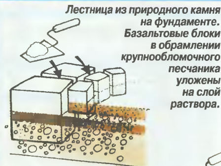
Ступени из голубого базальта с обрамлением из граувакки (крупнообломочного песчаника).
